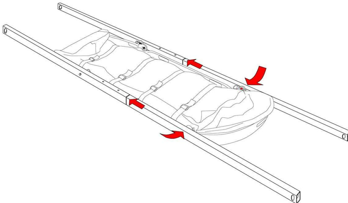
Il est important de bien s'assurer de la bonne mise en place des goupilles de verrouillage avant de commencer la descente.
